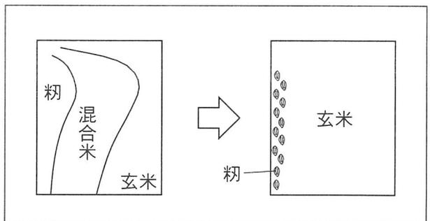
3. すり米が少なくなり、仕上米に粃が混入しそうになりましたら、仕上米レバーを **循環** にし、流量調節レバーを閉じてください。
