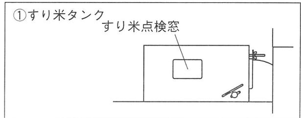
1. 粃入漏斗に粃がなくなり、すり米タンクのすり米がすり米点検窓から見えなくなりましたら、ただちに仕上米レバーを **循環** にしてください。
