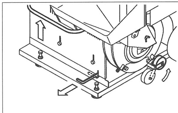
水準器で機体の水平を確認してください。
