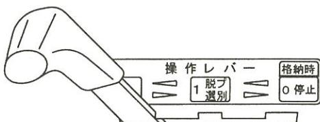
ただし、もみなし制御が「入」のときは、すり米タンク混合米が少なくなりますと揺動選別板が自動的に停止します。また、すり米タンクのすり米が適量になると自動的に揺動を開始します。
