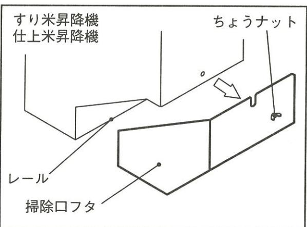
コンベア軸下方の掃除口フタをはずし、残留米をかき出してください。
