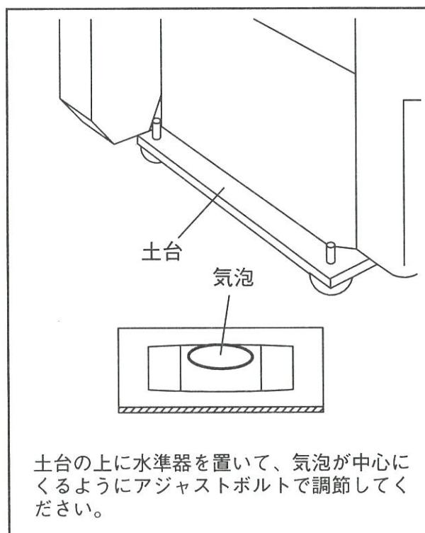
土台の上に水準器を置いて、気泡が中心にくるようにアジャストボルトで調節してください。
