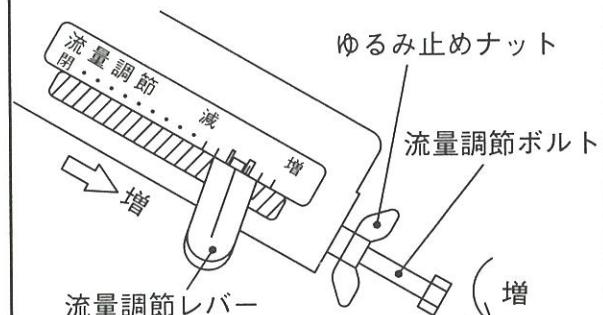
※調節後、ゆるみ止めナットを締めてください。
