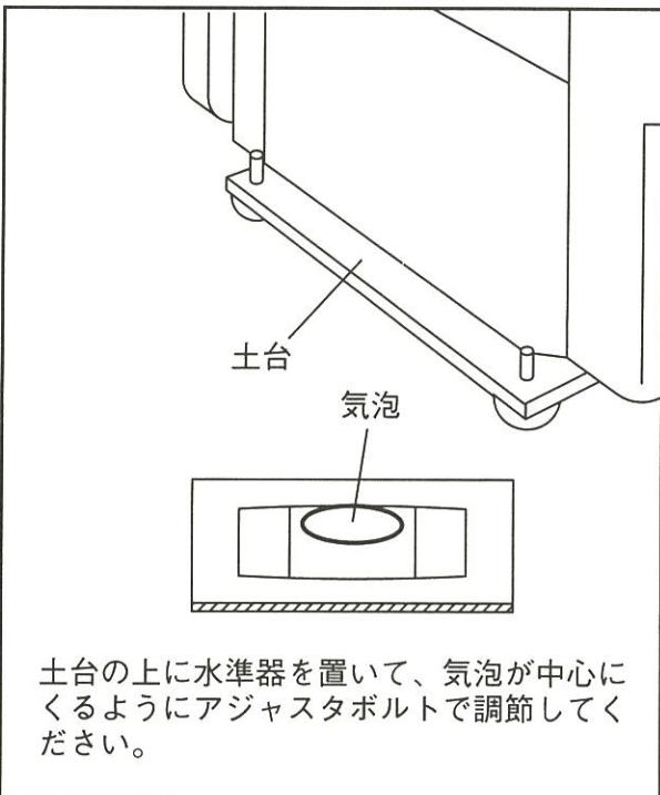
土台の上に水準器を置いて、気泡が中心にくるようにアジャスタボルトで調節してください。
