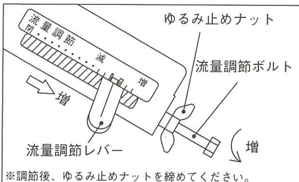
※調節後、ゆるみ止めナットを締めてください。
